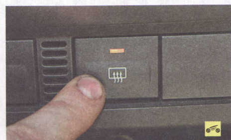
17 – прикуриватель. При нажатии на кнопку (ключ в выключателе зажигания должен находиться в положении «II») включается обогрев заднего стекла, одновременно в кнопке загорается контрольная лампа. При повторном нажатии на кнопку обогрев выключается.
