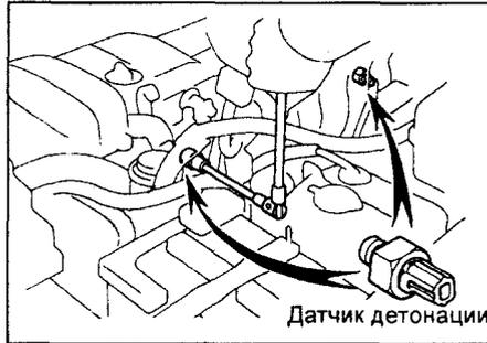
3. С помощью омметра убедитесь в отсутствии проводимости между разъемом датчика и его корпусом. В противном случае замените датчик.
