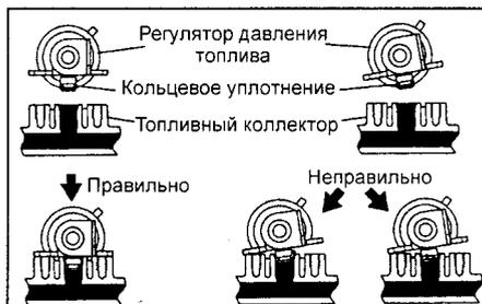
г) Закрепите регулятор двумя болтами.
