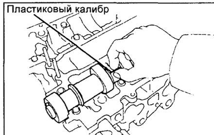
г) Установите крышки подшипников и затяните болты в указанной на рисунке последовательности.
