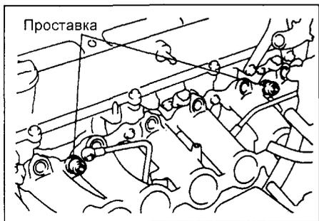
д) Снимите 6 изоляторов с топливного коллектора.
