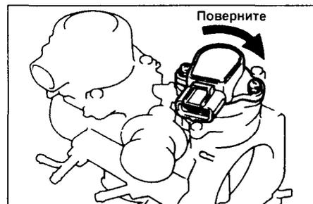
д) Проверьте проводимость между выводами "IDL" и "E2".
