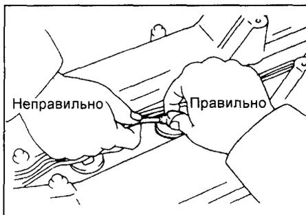
б) Отверните болт крепления зажима проводов от крышки №2 головки блока цилиндров.
