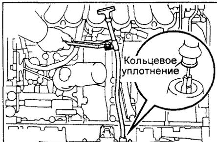
13. Установите электропневмоклапан и вакуумную трубку №2.
