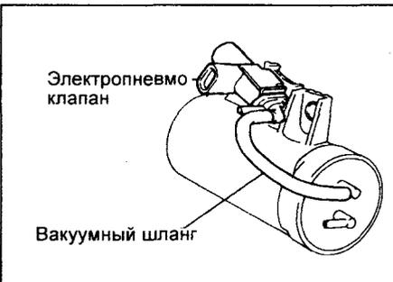
4. Установите узел вакуумного ресивера.
