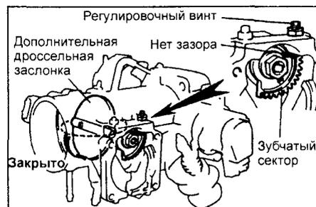
4. Проверьте датчик положения дополнительной дроссельной заслонки.
