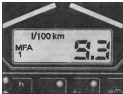
Рис. 1.16 Дисплей бортового микропроцессора - режим удельного расхода топлива
