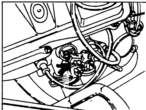
Рис. 4.54 Разъем датчика температуры охлаждающей жидкости (см. по стрелке)
