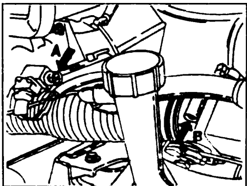
Рис. 4.55 Расположение винта регулировки содержания CO (А) и винта регулировки частоты XX (В)
