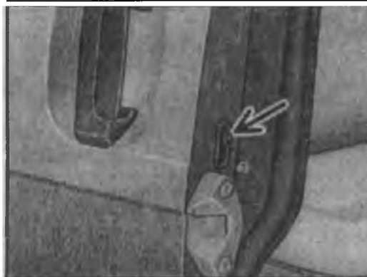
Рис. 1.5а Защелка безопасности сдвижной двери при перевозке детей
